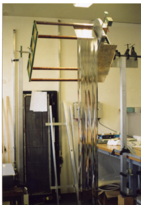
Obrázok 7.3: Stavba GTPC - ťaženie pásov (stripy) zabezpečujúcich homogénne driftové pole.
